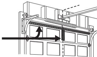
**REMARQUE :** Bon nombre de nécessaires de renforts de porte prévoient la fixation directe de l'axe de chape et de la bielle de porte. Dans ce cas, le support de porte ne sera pas nécessaire; passer à l'étape suivante.
